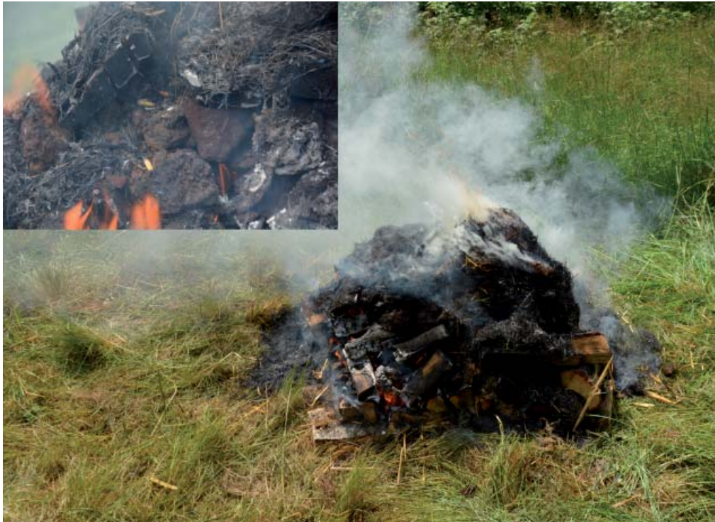
Figur 2. Sjömalm rostas på ett rostningsbål (Projektet Från Malm till Svärd, foto: Andreas Svensson)
