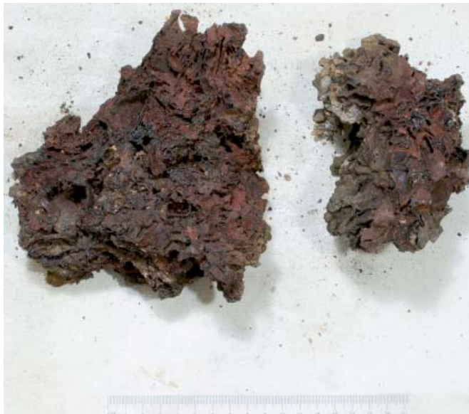
Figur 9. Bottenslagg från Ingebo med rödfärgning och avvikande utseende (foto: Andreas Svensson/Faber Arkeologi)
