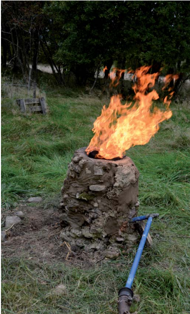
Figur 5. Mindre blästugn byggd för framställningsexperiment vid Thors Forge i Holma (Projektet Från Malm till Svärd, foto: Andreas Svensson)
