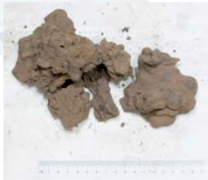
Figur 8. Reduktionslagg från Ingebo. Flutna stearinliknande formationer (foto: Andreas Svensson/Faber Arkeologi)
